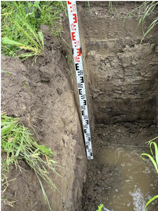
Trennlinie Schluff / Kies → Tiefe ~ 1,20 m
