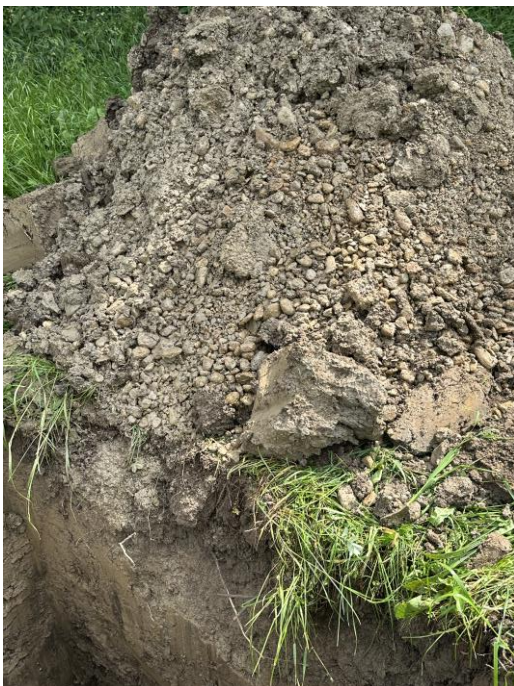
Trennlinie Schluff / Kies → Tiefe ~ 1,20 m
