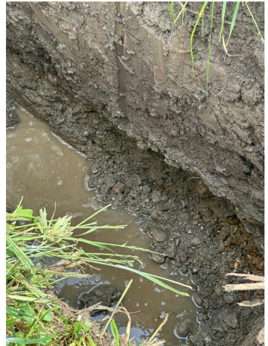
Trennlinie Schluff / Kies → Tiefe ~ 1,20 m
